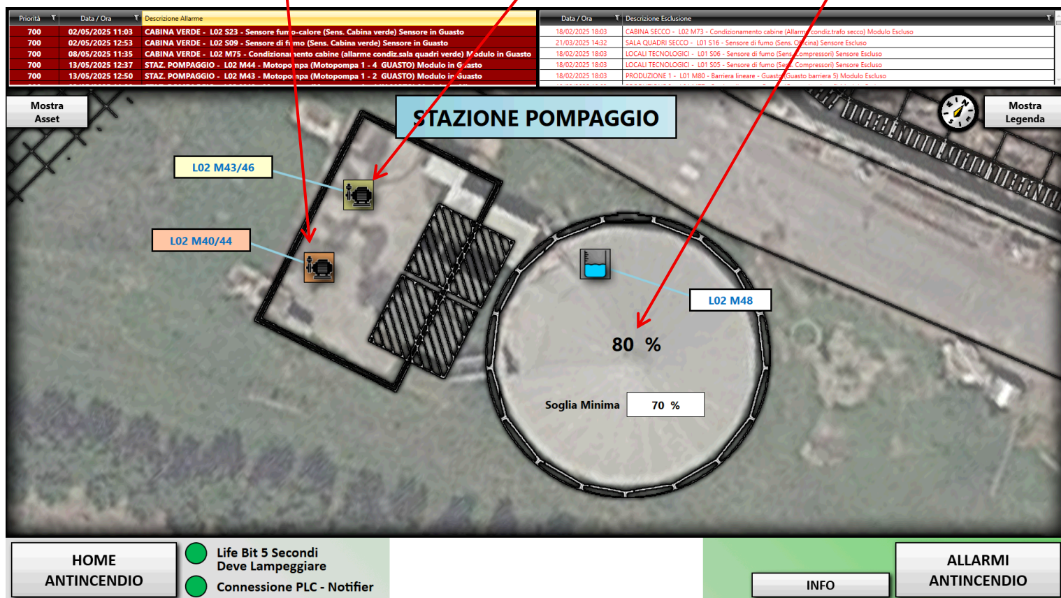
Figura 3 - Esempio supervisione realizzata - Schermata di ZONA
